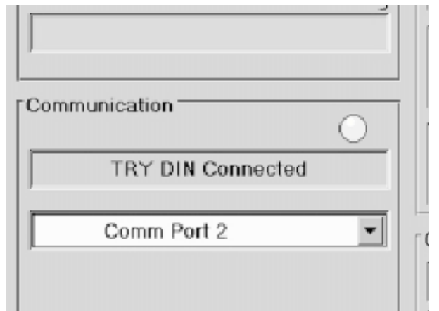
图8. 组态软件显示PC和变送器通信状态正常
